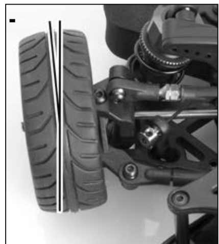
- Nachspur Toe Out Ouverture Convergencia negativa
